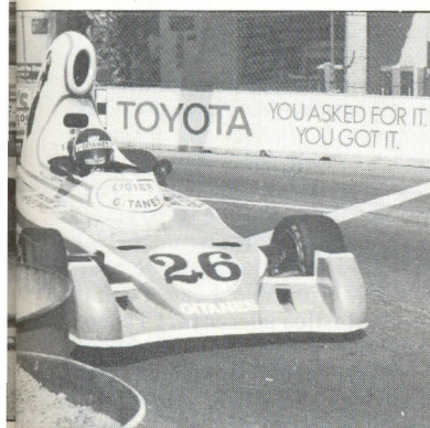
Sotto: ancora Laffite, a Long Beach 1976, sulla JS5 prima versione con la caratteristica presa d'aria a dorso di cammello (FotoLini)
