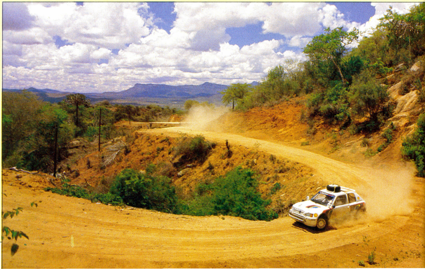
La Peugeot 205 turbo 16 in versione Safari vista al test kenyota si differenzia per alcuni particolari tecnici, fra i quali l'adozione di due ruote di scorta (una sul tetto) e lo speciale paraurti in lega di alluminio (sopra)
