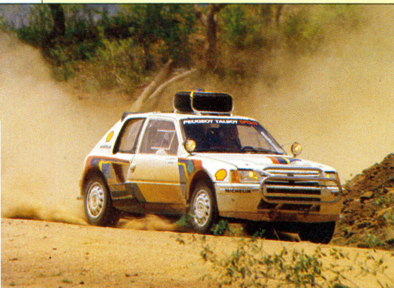
La Peugeot 205 turbo 16 in versione Safari vista al test kenyota si differenzia per alcuni particolari tecnici, fra i quali l'adozione di due ruote di scorta (una sul tetto) e lo speciale paraurti in lega di alluminio (sopra)
