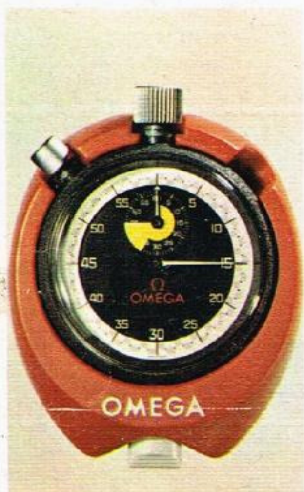
MG 6407 1/5 de segundo. 1 vuelta de la aguja en 60 segundos. Totalizador 60 minutos. Puesta en marcha y parada mediante presión sobre la corona.
