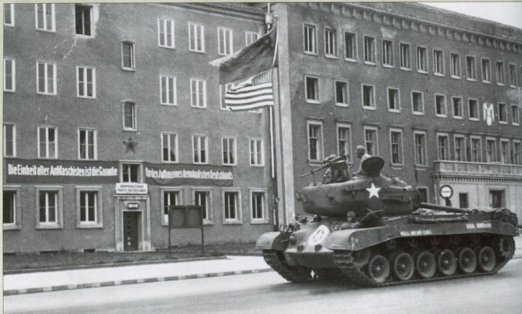
▲ Un M26 traverse une ville allemande. Le bon état des habitations laisse à penser que la guerre est finie depuis quelques mois. Pour faciliter la conduite en milieu urbain, la tourelle est orientée à « 6 heures ». L'engin est ainsi bien plus manoeuvrable dans les petites rues et le pilote n'a pas à penser au gabarit du tube de 90mm.
