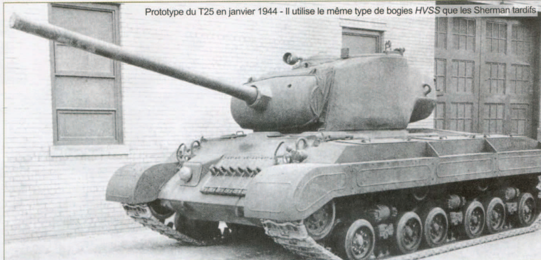
Prototype du T25 en janvier 1944 - Il utilise le même type de bogies HVSS que les Sherman tardifs
