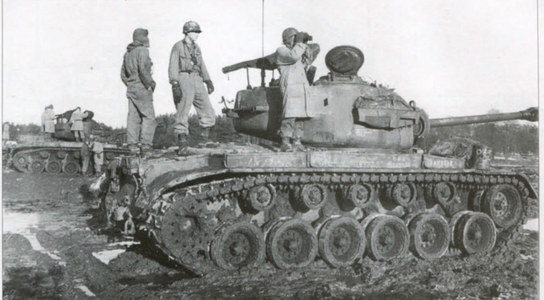
À l'entraînement sur un champ de tir. Notez les chenilles métalliques T81 à deux axes
