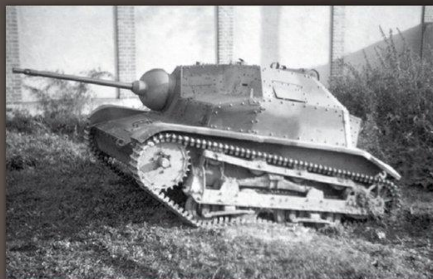
▲ Une tankette TKS armée d'une mitrailleuse lourde, selon la nomenclature de l'époque, de 20 mm WZ. 38 (modèle 1938), également connue sous le nom de FK-A, pour Fabryka Karabinów – modèle A. Officiellement, 574 chenillettes TK, TK-3 ou TKS sont disponibles. Toutes sont loin d'être opérationnelles et, par ailleurs, l'immense majorité n'est équipée que de mitrailleuses, seuls 24 exemplaires pourvus du 20 mm sont aptes à affronter les Panzer . - AMC # E011228
