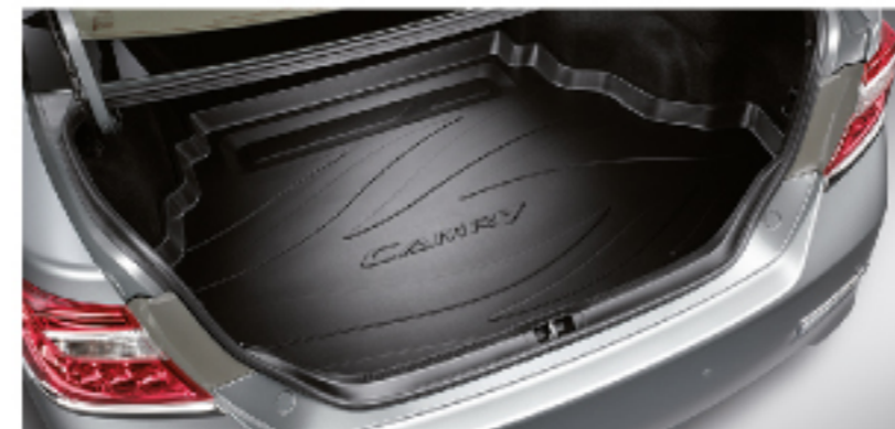
ถาดเก็บของท้ายรถ / Luggage Tray นลิตาควิสต์พลาสติก LDPE (Low Density Polyethylene) ทนต่ออุณหภูมิต่ำ-สูงได้ดี เน้แมท ทนทาน พื้นถาดออกแบบพิเศษ ช่วยลดการสั่นโถงของสินการะ
