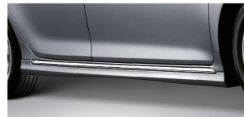
สเกิร์ตข้างขวา-ซ้าย / Side Skirt RH-LH อีกรัดแน่นของควาโดดเด่น นลิตาควิสต์ทรนพิเศษ TSOP (Toyota Super Orifin Plastic) น้าหนักเบา ทนทาน ไม่ยึดหรือบิดตัวตลอดอายุใช้งาน
