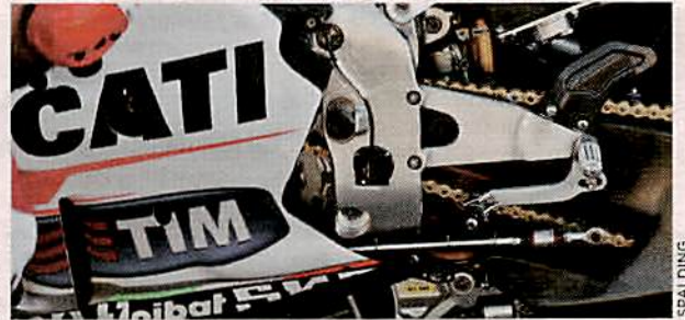
Ducati: Schwingenachse in tiefster Einstellung, Mess-Sensoren
