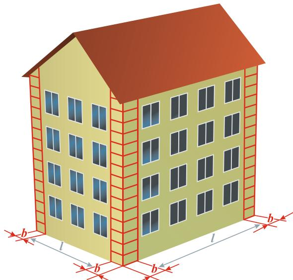
Точное количество держателей теплоизоляционных материалов, устанавливаемых на 1 м<sup>2</sup> утепляемой поверхности определяется согласно п. 6.10 ТКП 45-3.02-113-2009.
