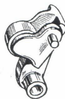
8. á. A bütyökhimbák görgői szabadon forognak és egész felületükön egyenletesen körkörösök legyenek. Ha rajtuk laposra kopott részt találunk, úgy sürgősen új görgőt kell vásárolni, ellenkező esetben a szelephézag beállítása lehetetlen, a motor teljesítménye csökken.
