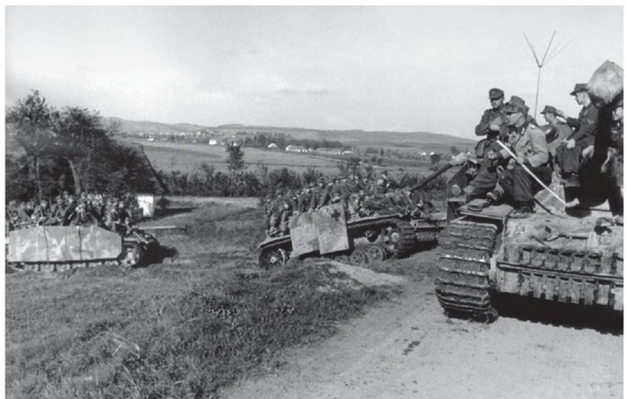
▲ Une colonne de StuG III transportant des fantassins « à la russe » en Roumanie. L'engin au premier plan est un engin de commandement, reconnaissable à l'antenne en « parapluie » visible à l'arrière du blindé. NAC
