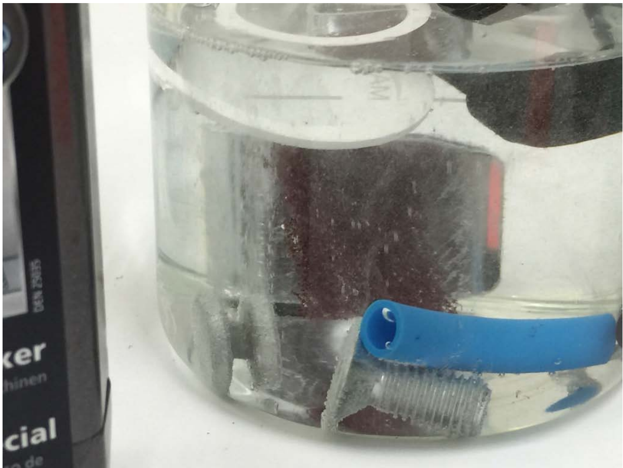
ABBILDUNG 8 – REAKTION DURGOL DIREKT NACH ZUGABE DER ENTKALKERLÖSUNG
