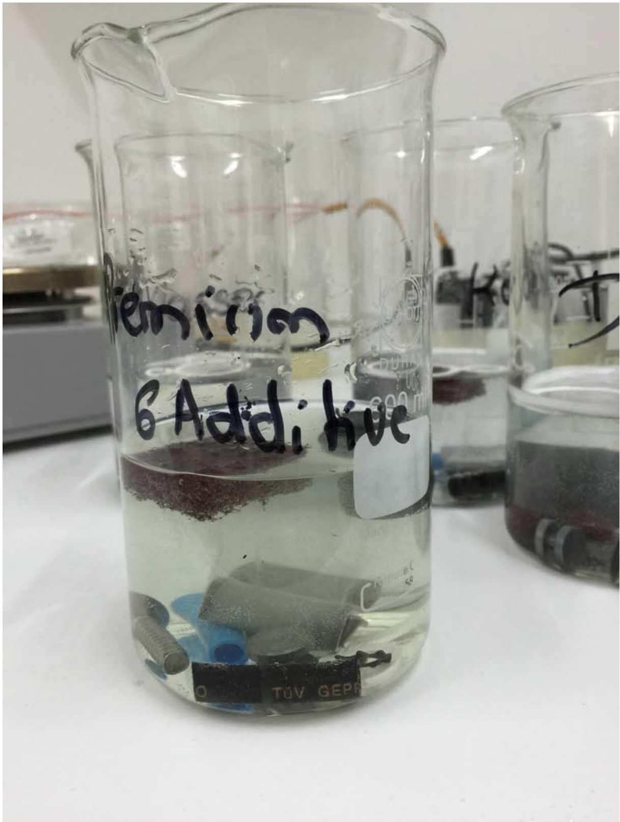
ABBILDUNG 22 – CERAGOL ENTKALKERLÖSUNG NACH ABSCHLUSS VON 20 ENTKALKUNGEN
