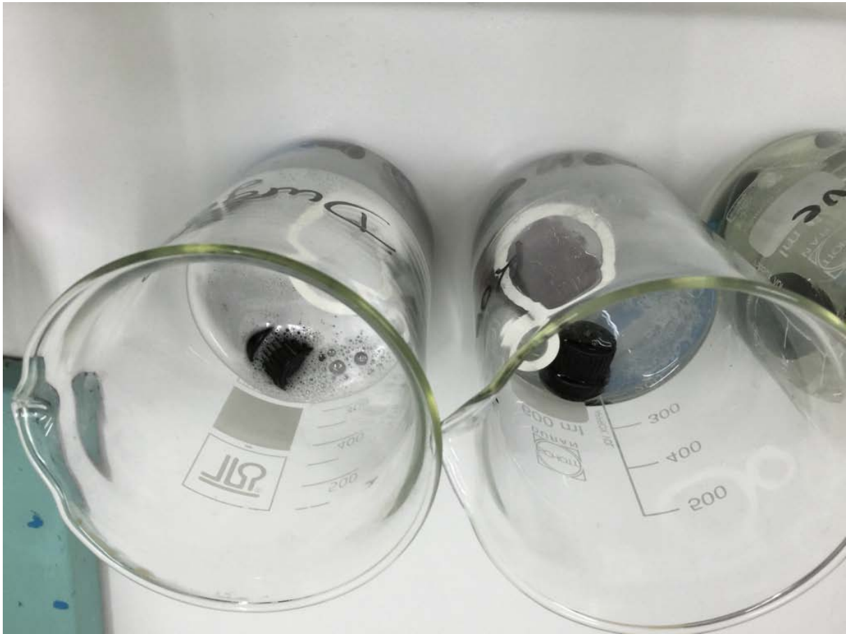
ABBILDUNG 18 – REAKTION ENTKALKERLÖSUNGEN NACH 5 HEISSENTKALKUNGEN (LINKS DURGOL, RECHTS KOENIC)
