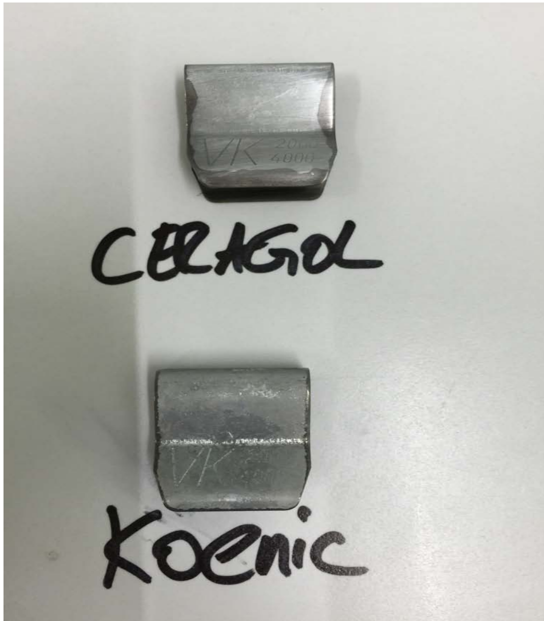
ABBILDUNG 24 – METALLKLAMMERN NACH ABSCHLUSS VON 20 ENTKALKUNGEN MIT CERAGOL UND KOENIC ENTKALKERLÖSUNG
