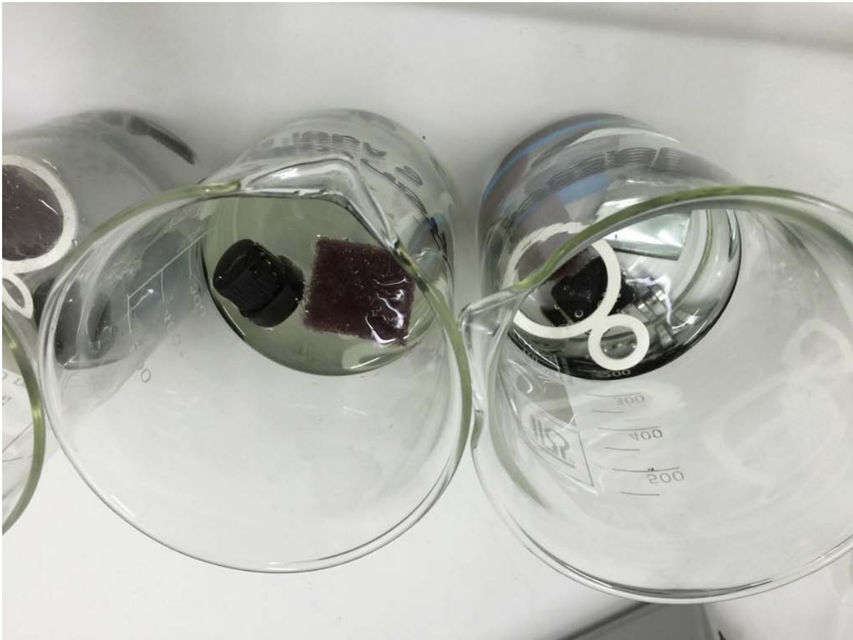
ABBILDUNG 19 – REAKTION ENTKALKERLÖSUNGEN NACH FÜNF HEISSENTKALKUNGEN (LINKS CERAGOL, RECHTS PLACEBOLÖSUNG)
