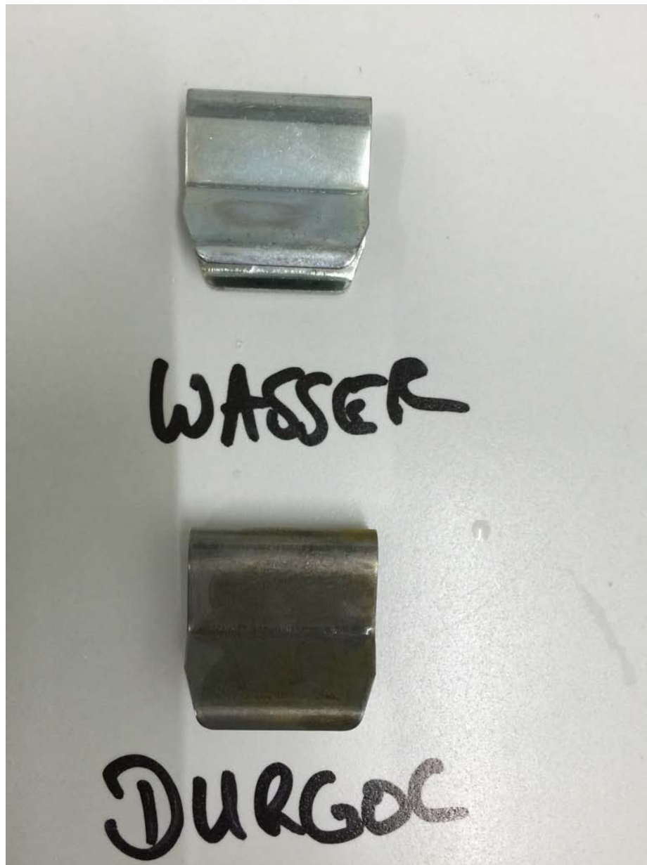
ABBILDUNG 25 – METALLKLAMMERN NACH ABSCHLUSS VON 20 ENTKALKUNGEN MIT PLACEBO UND DURGOL ENTKALKERLÖSUNG
