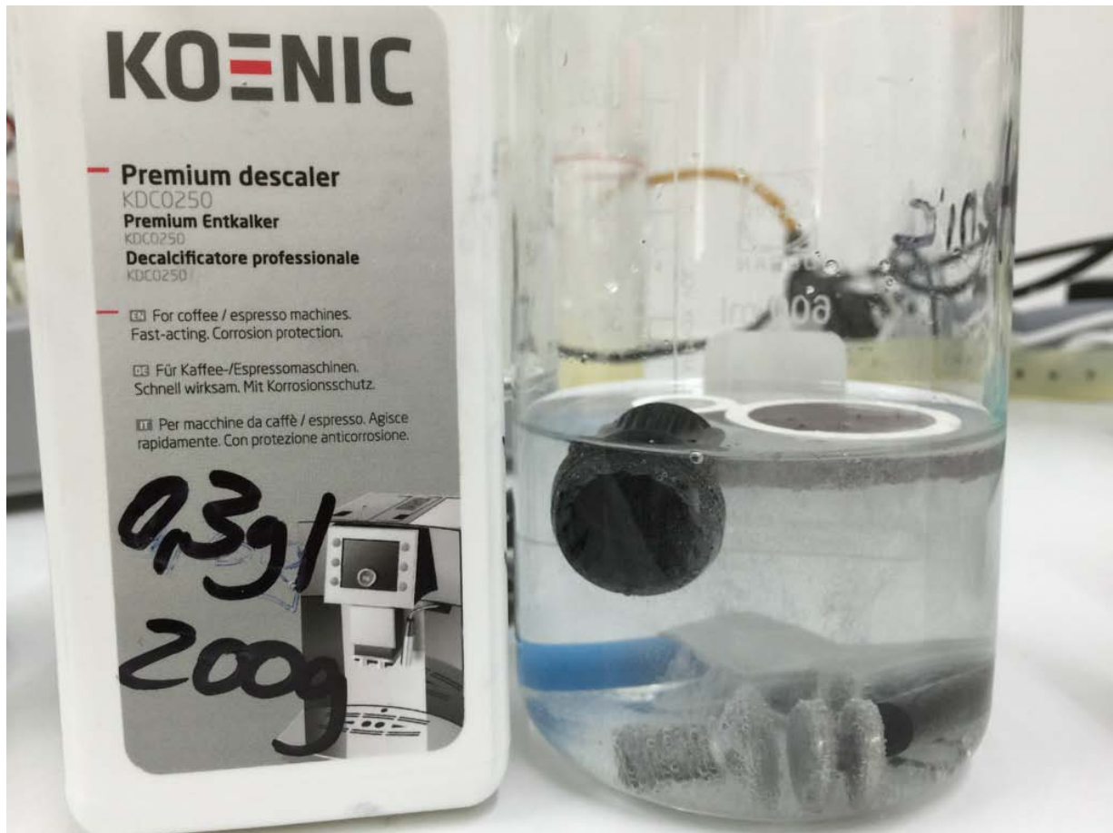
ABBILDUNG 10 – REAKTION KOENIC NACH ERSTER HEISSENTKALKUNG
