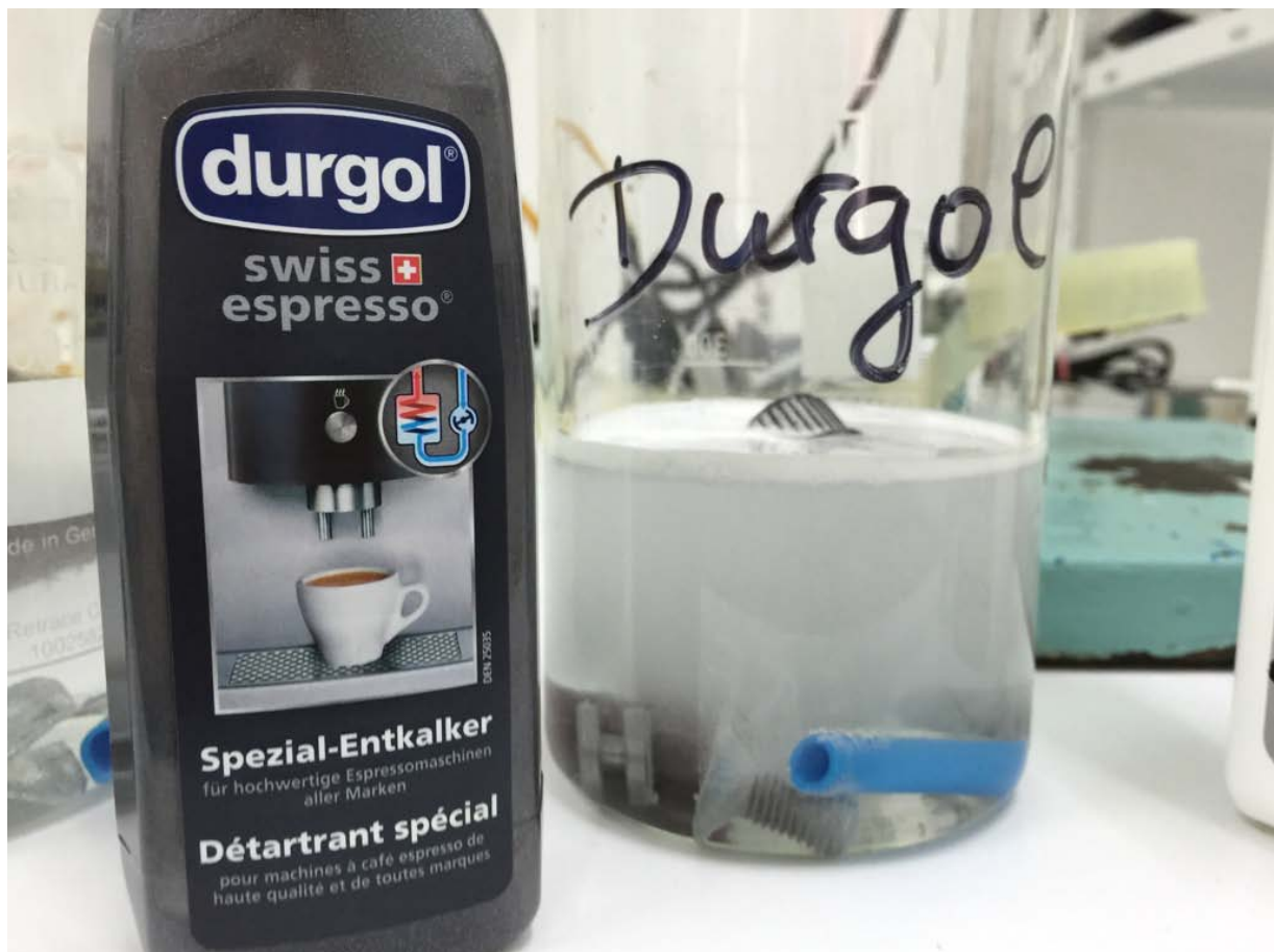
ABBILDUNG 9 – REAKTION DURGOL NACH ERSTER HEISSENTKALKUNG
