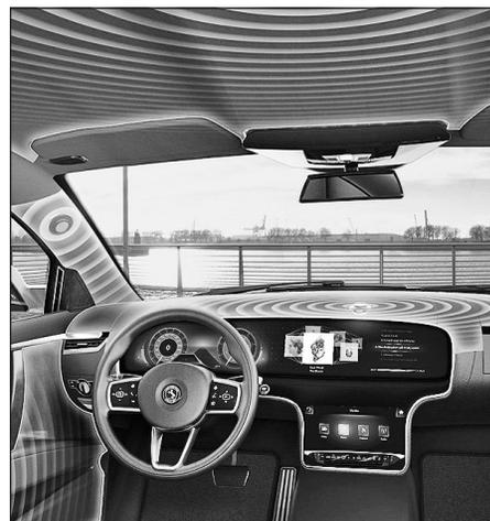
Производитель утверждает, что сейчас колонки в обычных автомобильных аудиосистемах весят до 20 килограммов, а все элементы разработки Continental вместе взятые – не больше двух килограммов. Также комплекс позволяет не только снизить массу машины, но и уменьшить энергопотребление.
