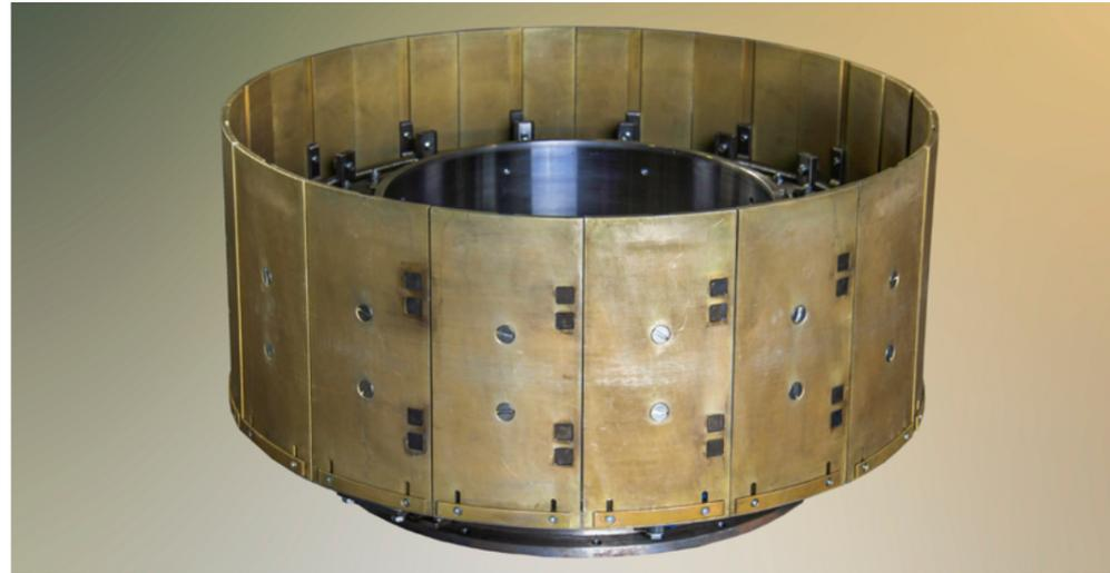
Брекерный барабан устанавливается на станок СПК-23 и предназначен для сборки брекерного браслета на покрывку 11.00R20.
