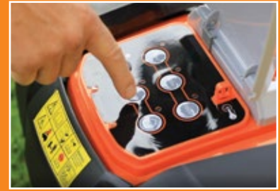
Podešavanje površine košenja Izborom jedne od komandi na kontrolnoj tabli vrši se zadavanje površine košenja
