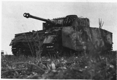
Bild 4: So wurden die Schürzen an den Seiten und um den Turm angebracht. Was wohl die beiden Löcher unten in der Schürze bedeuten?
