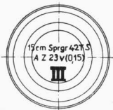
Bodenansicht einer 15 cm Sprgr 42 TS mit Rauchentzicker
