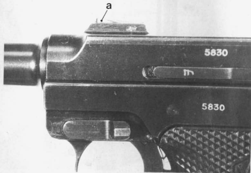
Bild 9: Der Ladeanzeiger a der finnischen Lahti.
