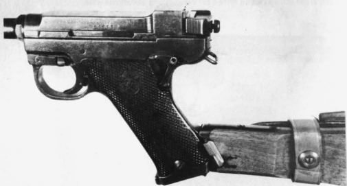
Bild 6: Schwedische Pistole m/40 mit angestecktem und verriegeltem Anschlagbrett einer langen Pistole O8.
