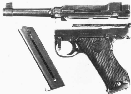
Bild 25: Schwedische Pistole m/40 in die Hauptteile zerlegt.
