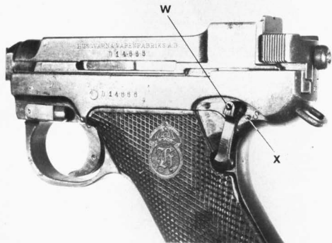
Bild 30: Zur leichteren Demontage der linken Griffschale kann der Sicherungshebel an der Bohrung w nach außen gebogen werden. x = Begrenzungsstift.
