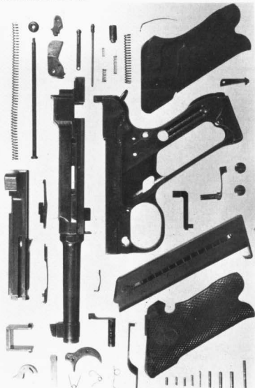
Bild 31: Die schwedische Pistole m./40 in sämtliche Einzelteile zerlegt.
