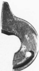
Bild 29: Schleuderhebel mit Führungsstift und Feder.
