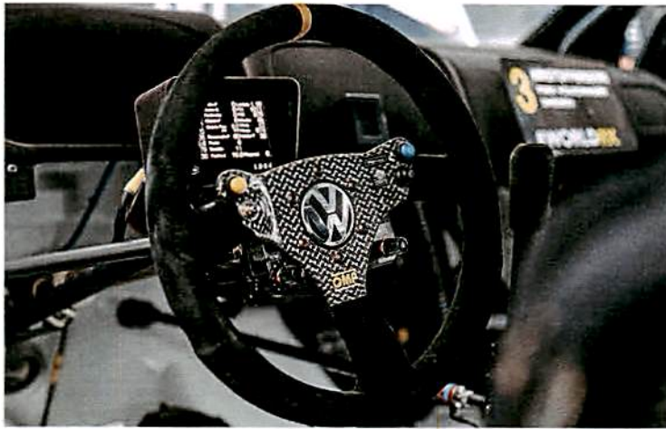
Steueroase: Das Supercar-Lenkrad von Solberg ist aus Verbundstoffen
