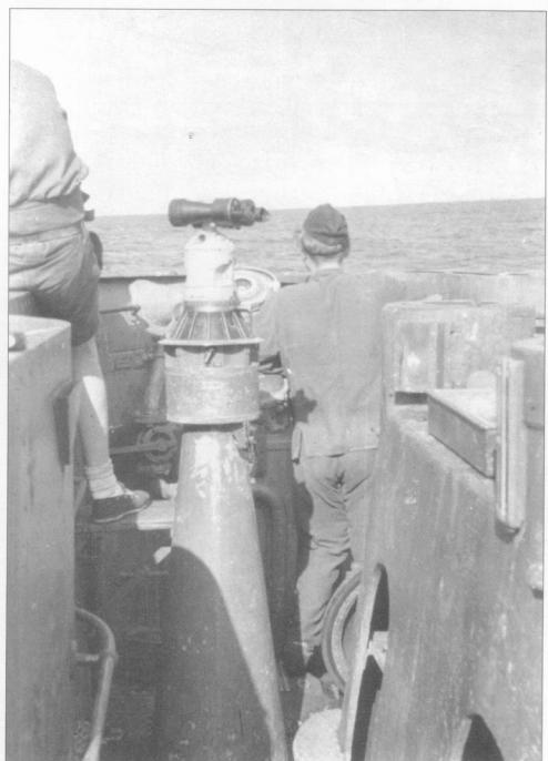
**U 106** (Typ IX B), jeden z uczestników wachty podczas obserwacji za pomocą celownika dla nawodnych strzała torpedowych typu UDF 7x50. • A member of a watch on **U 106** observing the horizon through a UDF 7x50 sight used for surface firing of torpedoes.
