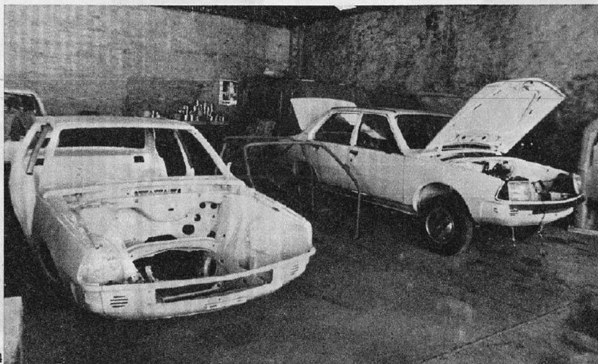
11. Casco del Renault 18 GTX EL que se preparó para Gabriel Raies en el taller de Sigfrido Schroeder en Córdoba. Notar el trabajo de alivianamiento realizado. 12. Motor del Volkswagen Golf GTI. Posee cuatro válvulas por cilindro y en su primera carrera logró el segundo puesto con Ludwig Damminger. 13. Protección interior del Mazda 323 FWD. Ver abajo a la izquierda un dispositivo aerodinámico. 14 Otra toma del taller de Osvaldo Batelli. En primer plano el mono casco del R-18 de Miguel Torrás, y más atrás, el auto que utilizará Ernesto Soto en pleno proceso de armado. La jaula antivuelco entre ambos corresponde a Torrás. 15. Grupo motor y transmisión del Mazda 323 FWD.
