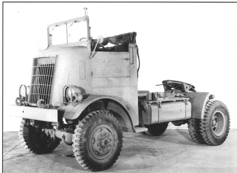
La version finale à cabine torpédo donne une désignation de 94x43C avec un tout nouveau réservoir à embout large et latéral. Le feu de est venu prendre position sur l'aile droite et le nez a perdu son fanion. (Photo US Army Signal Corps)
