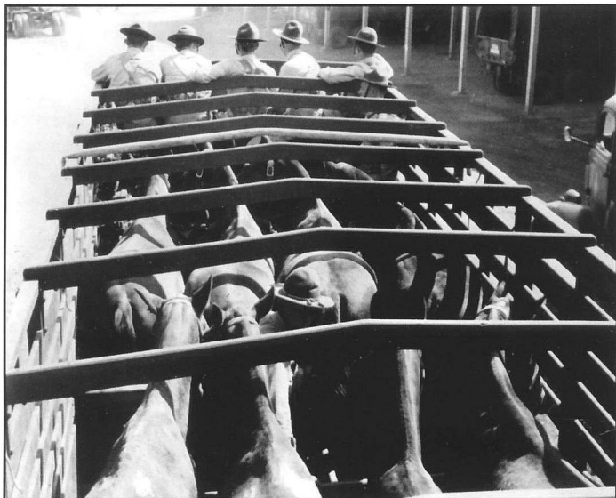
Dans la Semitrailer, Combination Animal and Cargo, 6-ton hommes et animaux se côtoient dans un même espace. Quand elle est débâchée, les soldats peuvent occuper une position «privilegiée». Le véhicule sur la droite est un tracteur GMC mais du type 4x2. (Photo US Army SC-117259)
