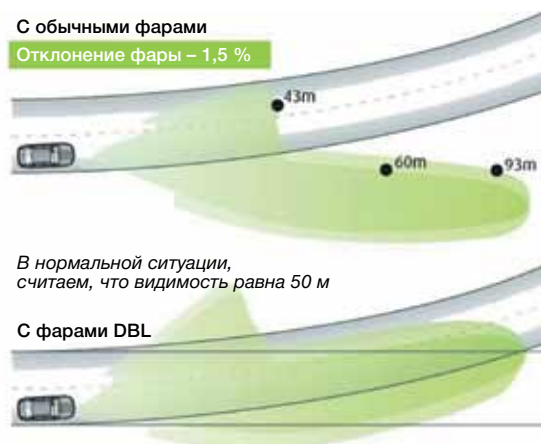
Рис. 3. Сравнение освещения при повороте для машины с обычными фарами (вверху) и с функцией DBL (внизу)
