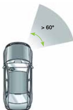
Рис. 2. Благодаря системе Corner угол поворота удалось увеличить до 60°
