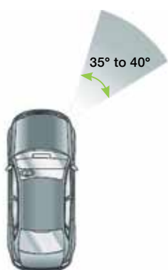
Рис. 1. FBL позволило вылечить «детскую болезнь» поворотных систем – запаздывание синхронизации на больших скоростях
