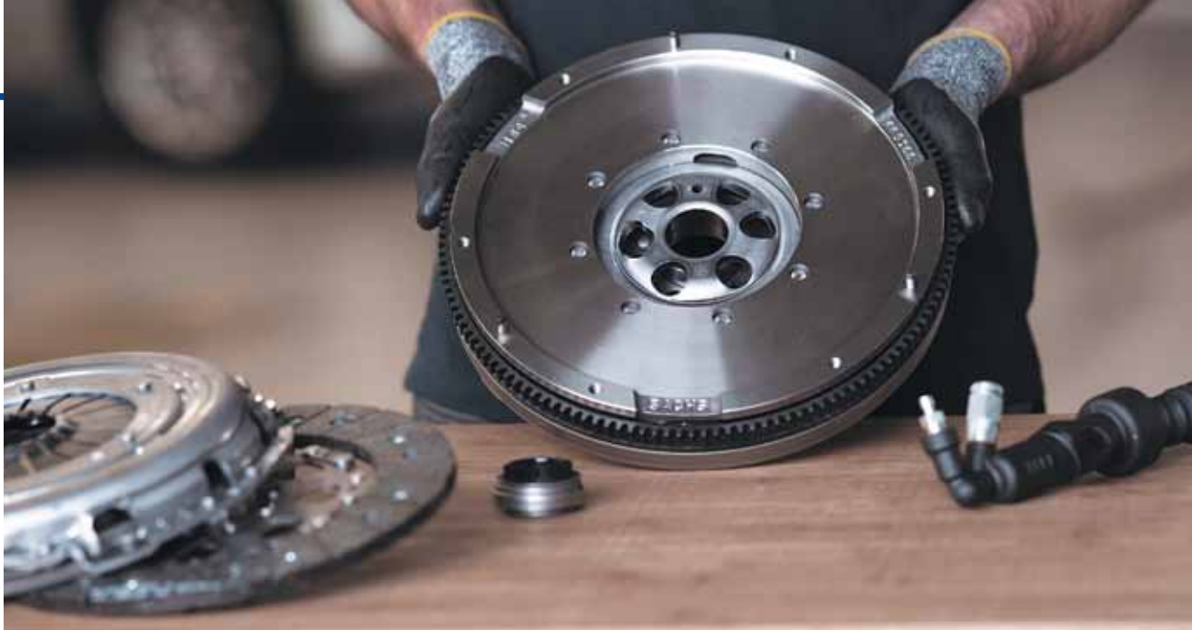
Перед монтажом необходимо внимательно проверить диск сцепления
