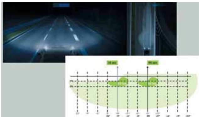
Рис. 6. Режим работы «по умолчанию» Full AFS – это ближний свет, а на его основе строятся уже другие режимы
