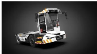
Un tracteur de parc ATM® 38T "FULL ELEC" de la gamme logistique GAUSSIN pour transporter des remorques et semi-remorques
