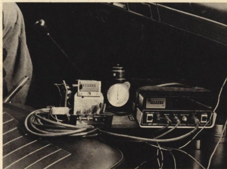
A KÖTUKI japán gyártmányú fogyasztásmérője — a legpontosabb az országban. A méréseket ezzel az 1 cm 3 -es pontosságú műszerrel végezték
