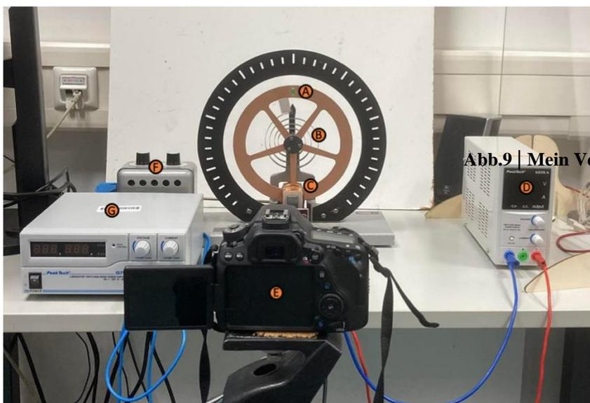
Abb.9 | Mein Versuchsaufbau für Messungen mit dem Pohl'schen Resonator
