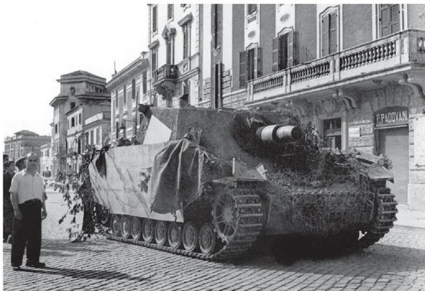
▲ Ce Sturmpanzer IV a été abandonné intact par son équipage. Peut-être a-t-il été victime d'une panne d'essence ou d'un problème mécanique. La surcharge pondérale (3 tonnes de plus que le Panzer IV dont il reprend le châssis) affecte en effet les organes de transmission, comme la boîte de vitesses ou l'embrayage.
