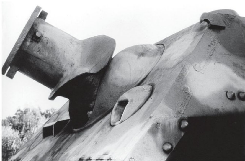
▼ Le Sturmtiger est doté d'un lance-roquettes de 38cm, un record pour un canon d'assaut. BTM
