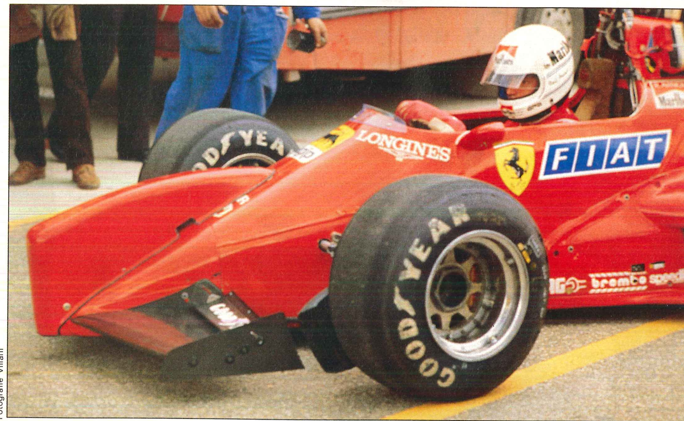
Una nuova Ferrari? No, è la vecchia C3 adattata a laboratorio. Il muso a capodoglio contiene apparecchiature elettroniche
