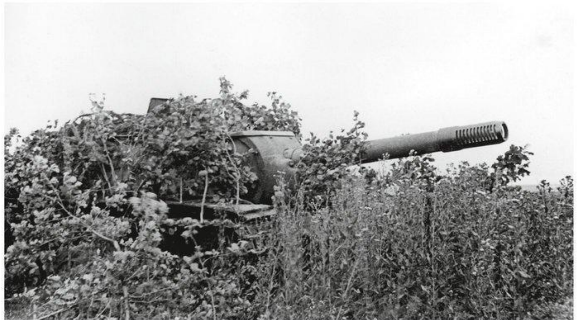
▲ SU-152 camouflé dans l'attente de l'ennemi. Basé sur le châssis KV et armé d'un puissant obusier de 152 mm en casemate, cet imposant engin de 45 tonnes est produit à 700 exemplaires avant d'être remplacé par l'ISU-152, adaptation du concept mais cette fois sur châssis de char JS-2. DR
