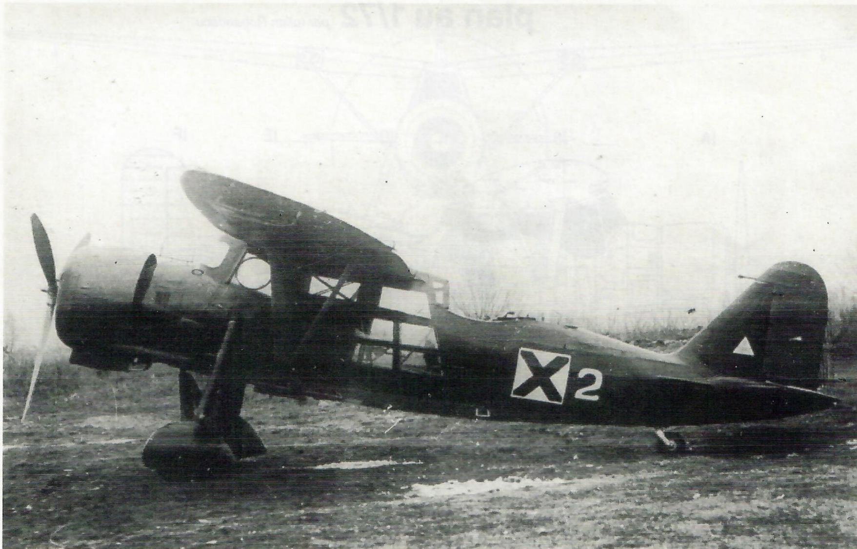
Le 2ème prototype du KB-11 était encore équipé, comme le n°1, d'un moteur Alfa Romeo et d'une hélice tripale. (photos ANDREEV)
