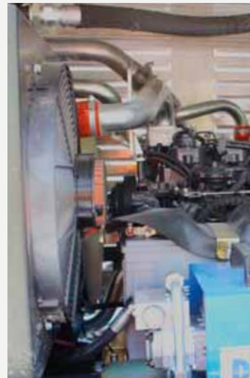
Lisävarusteet sijoitetaan koneessa suoja hitsausaggregaatti ja vesipumppu. Suod
