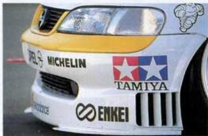
アウディやアコードと同様にラジエターからのエアはサイドから抜く Fブレーキは4ポッド2連装。リムはエンケイ・1ピース リヤウイングは暫定的に旧タイプのまま
