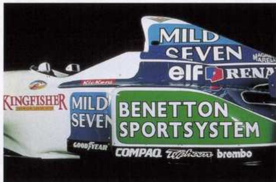
レギュレーション変更でドライバー頭部を保護するパッドの装着が義務付けられ、肥大化したコクピットの処理は今年の大きなポイント。ベネトンにはコクピットサイドの膨らみをなだらかにリヤボディへと導いている。後端を急激に落としこんだ短いサイドポッドの形状も特徴的だ
