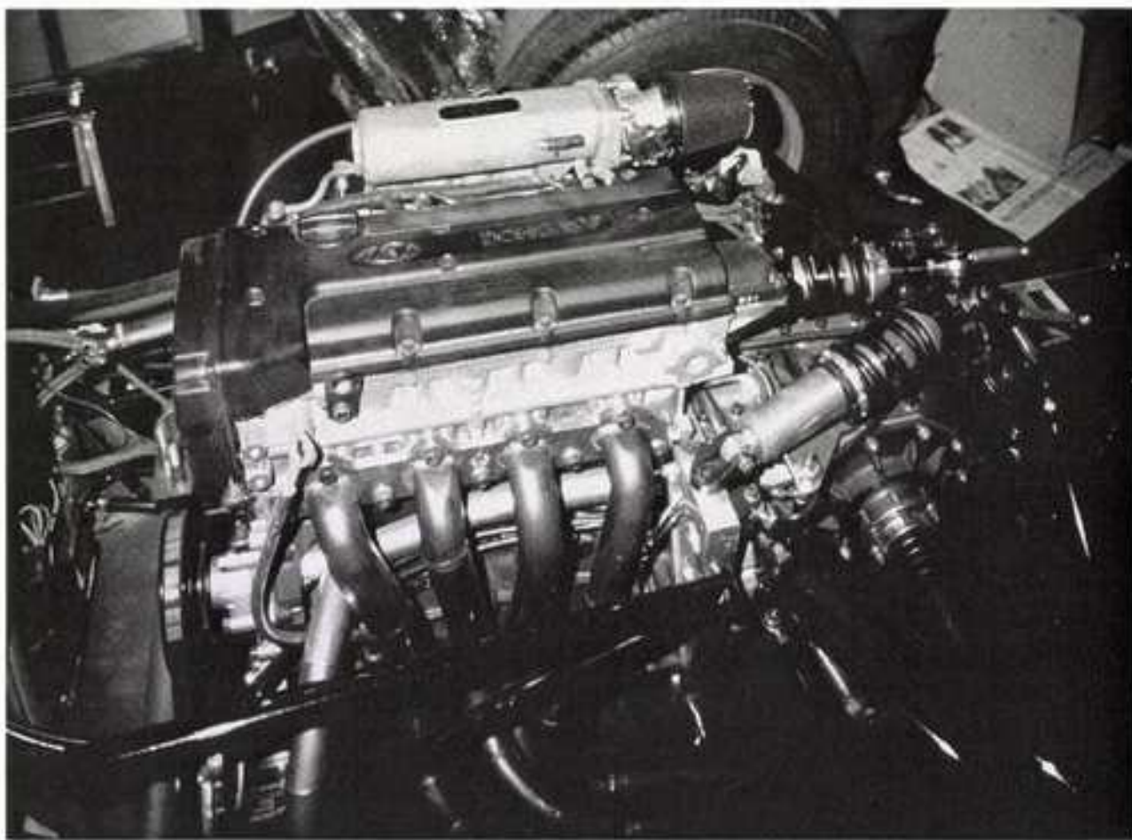
JK96FXに搭載されているのは現代社製の直4 1600ccエンジンだが、起亜社の直4エンジンの搭載も可能
