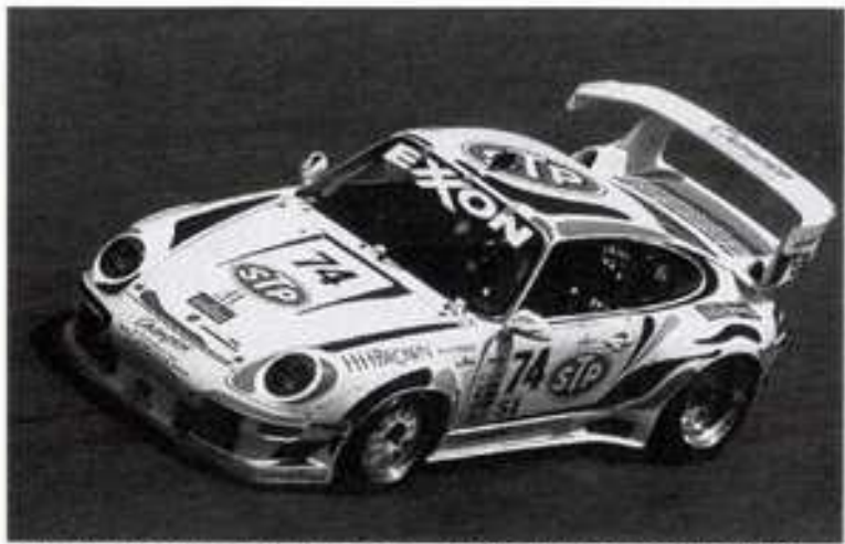
大型リアウイング、フロントスポイラー横側のエア出口などが特徴のEVO
