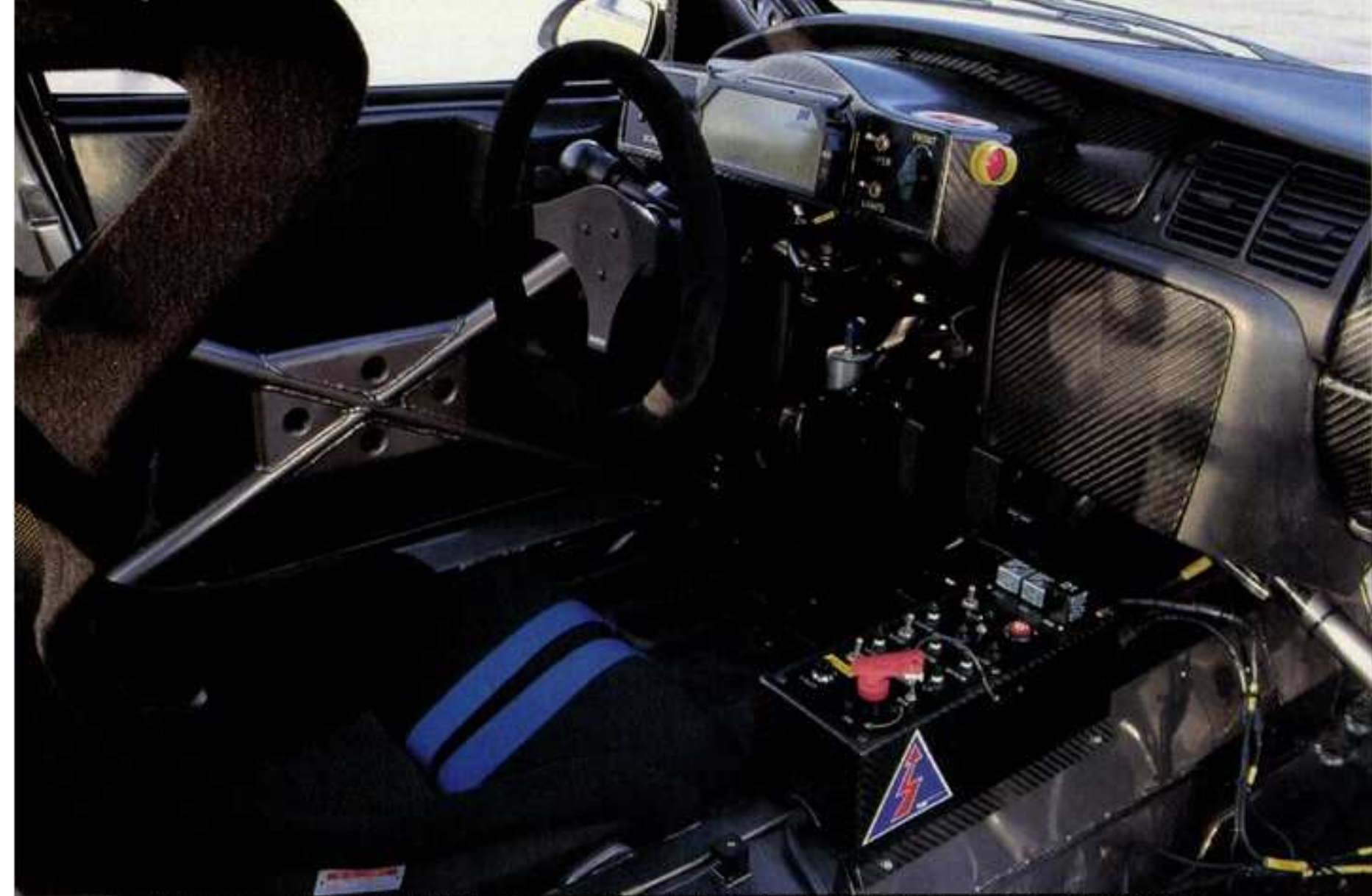
PIシステムはスーパーツーリングのもはや定番。コラムのシーケンシャルシフトは長谷見のリクエストでブルアップ、プッシュダウンに改められた
