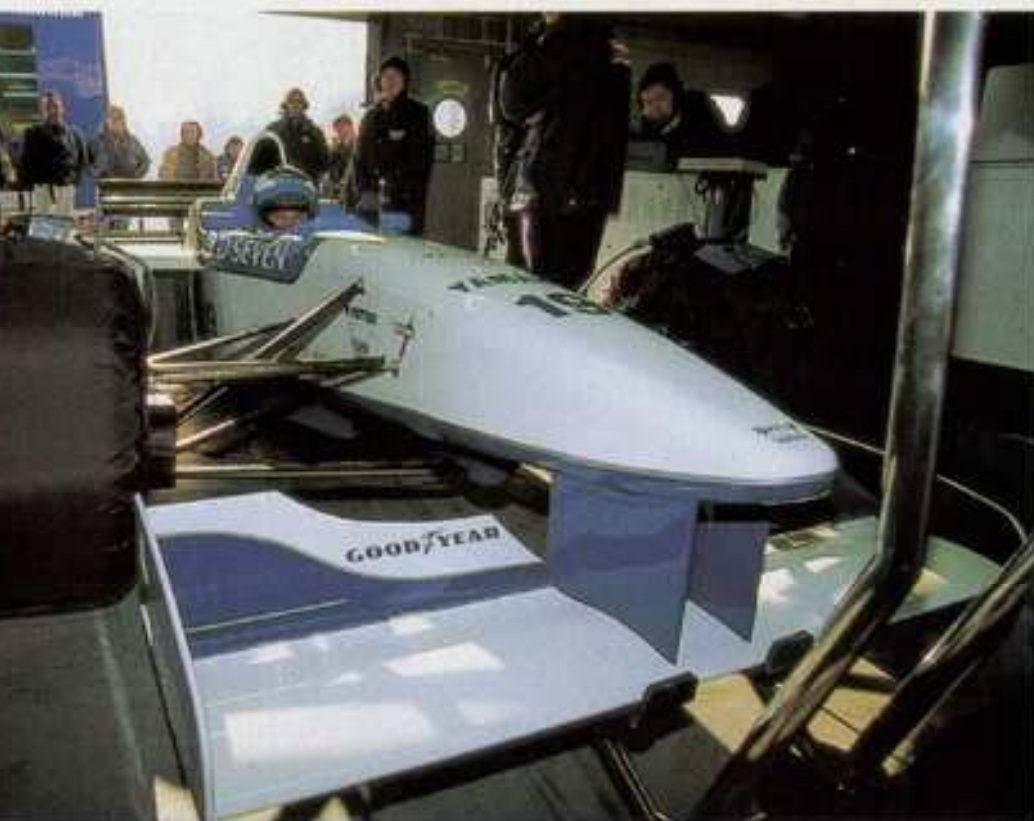
ノーズとフロントウィングの処理はベネトンの。昨年苦しんだハイドロリンクからコンベンショナルなプッシュロッド式になったサスペンションは、ピッチ制御のための第3のスプリングダンパーユニットを備えている。シーズン途中からは改造型ハイドロリンク投入の予定だというが……
