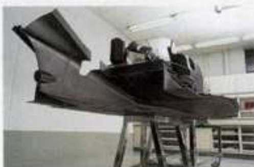
ディフューザー部分からステップフロアをのぞく
