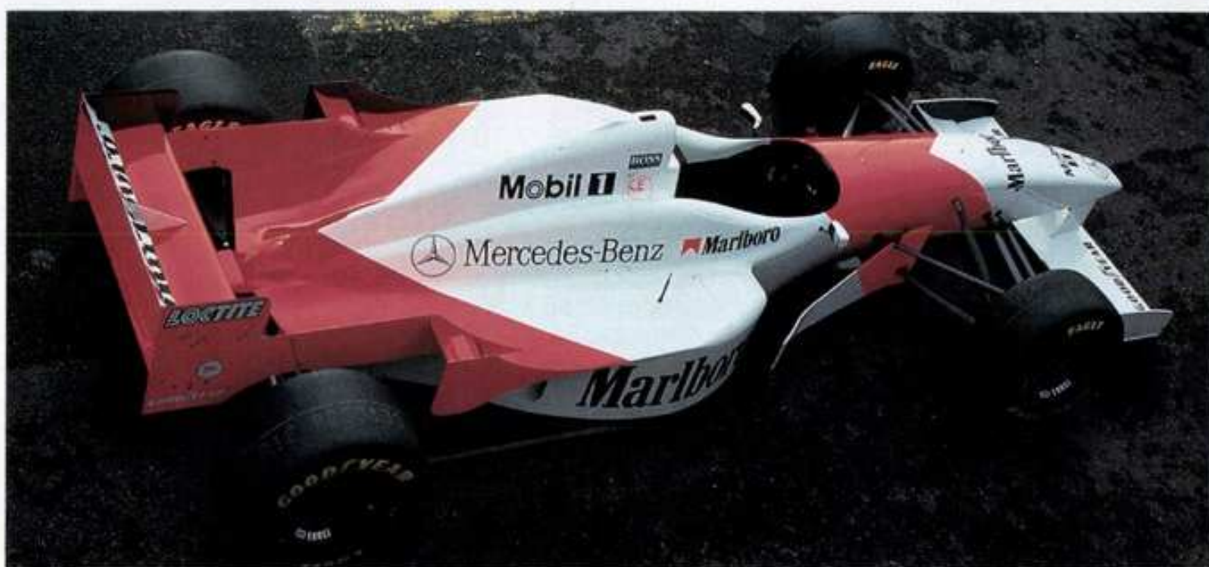
コクピットサイドの張り出しをきれいに後方へと流したまとまりのあるデザイン。リヤボディのフラットデッキ化、+前方へ伸びた翼端板は今年のトレンドだ
