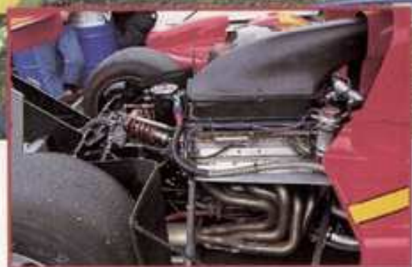
フェラーリ製4.0 V12エンジンをミッドにマウント
