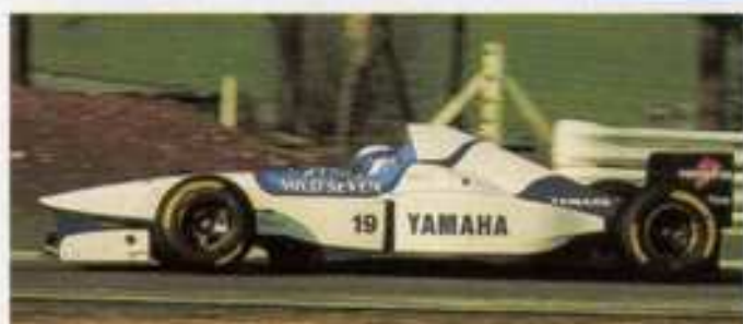
コクピットサイドの膨らみを短い区間で一気に収束させているのがティレル。スリムなエンジンカウルのメリットを生かしたかったためか……? 023で特徴的だったサイドポッド後端の大きな落としこみが廃止されたのはベネトンと対照的だ
