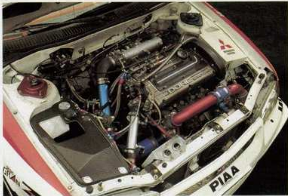
エボリューションIIIの登場とともに装着されたPCCを得て、レスポンスが向上した4G63
