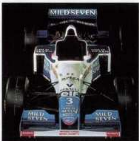
正面のアンクルからは大きくなったコクピットサイドの張り出しと、フラットになったサイドポッドの変化がよく分かる。リヤウイング翼端板の前端には小さなウイングレットが追加されている
