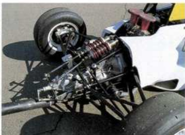
フレームを簡単に取り外せるようにしたことで、リヤの整備性をアップ
