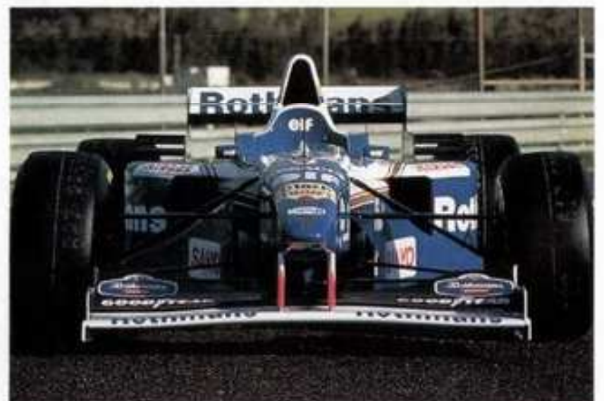
コクピットまわり以外に大きな変化はない。ベネトン同様のウィングレットを採用
