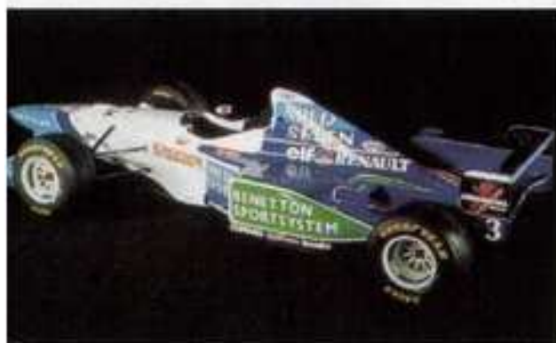
特徴的なリヤビュー。前方まで延びた翼端板とサイドポッド後部の絞りこみによって、コクピット以降の気流はウイングとディフューザー上面へと整理されて導かれる。リヤボディ上面からウイングへの造形は今年の大きなポイントとなりそうだ
