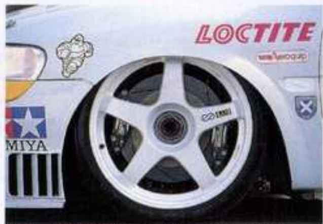
アウディやアコードと同様にラジエターからのエアはサイドから抜く Fブレーキは4ポッド2連装。リムはエンケイ・1ピース リヤウイングは暫定的に旧タイプのまま
