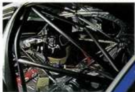
右上：制動力強化のためフロントはツインキャリアーを装備。左上：リヤはストラットを採用。下：ロールケージの剛性はさらに強化
