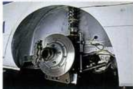
右上：制動力強化のためフロントはツインキャリアーを装備。左上：リヤはストラットを採用。下：ロールケージの剛性はさらに強化
