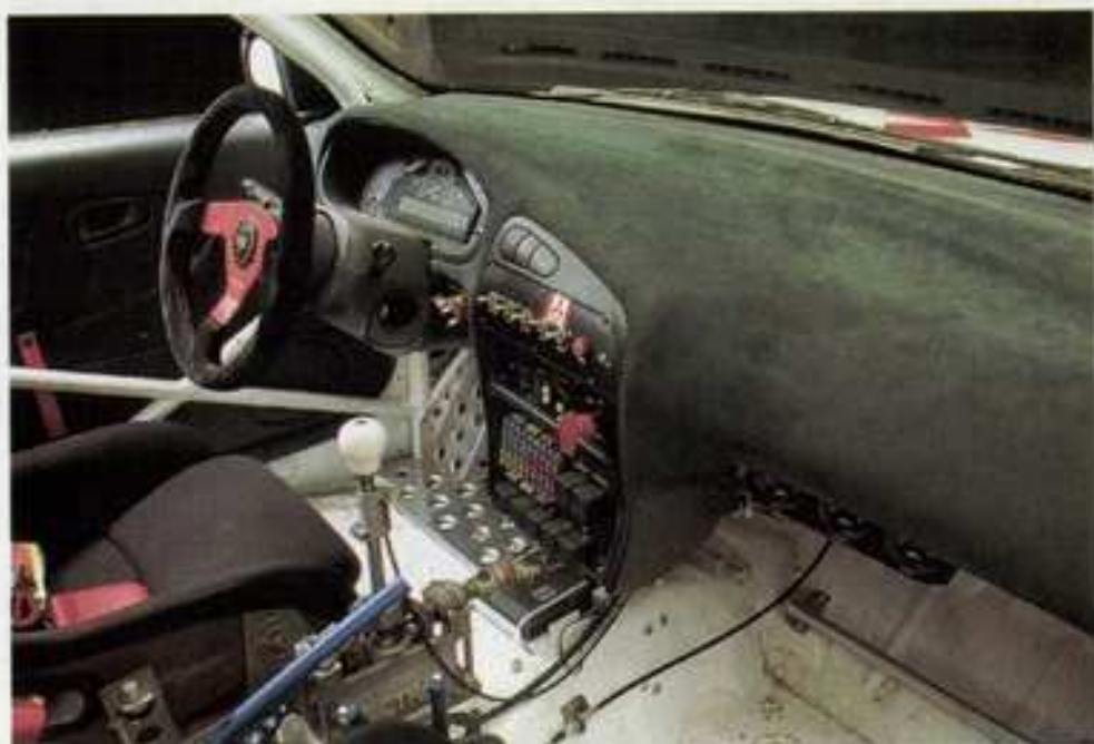
市販車と見間違ふほどきれいに仕上げられた室内。シフトはXトラック製で、サイドブレーキも装着
