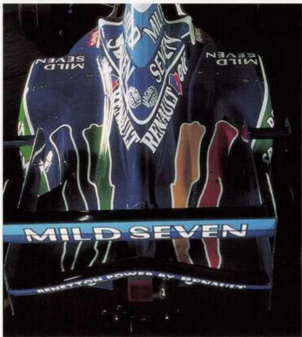
B196で最も注目されるのがリヤボディ上面のデザイン。B195でリヤサスペンションのアップアームを覆っていたフェアリングはフラットデッキへと発展し、リヤタイヤ前方まで伸ばされたリヤウイング翼端板によって、ウイングに効率良く気流を導く。特徴的なミドルウイングは今年も採用されている
