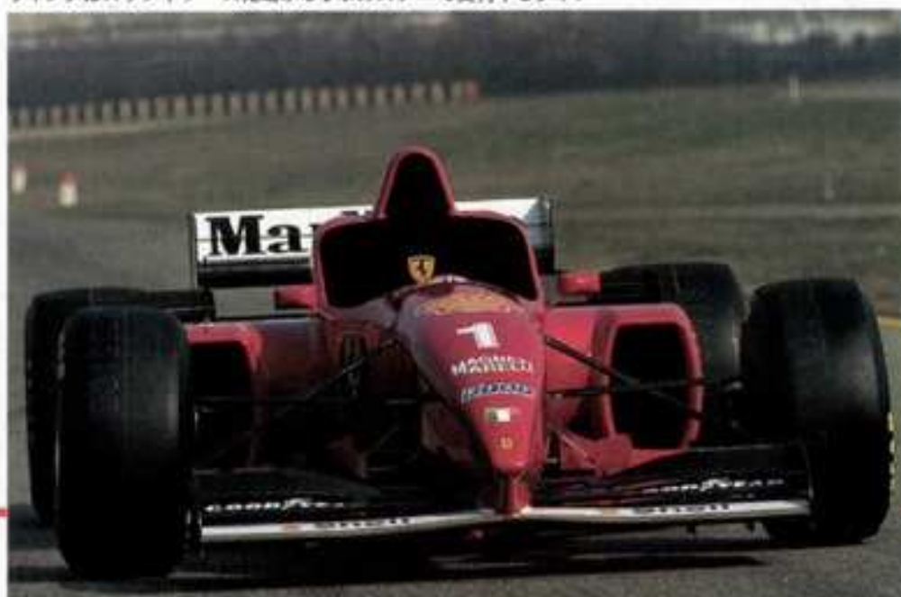
ウイングはスラントノーズ先端から1本のステーで支持するタイプ
