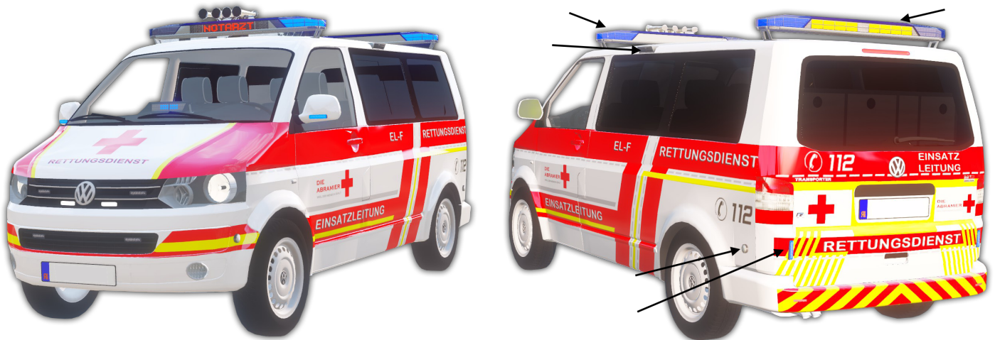
Rettungsdienst Version mit den neuen Blaulichtbalken und Flutlicht! (Pfeile zeigen die Neuerungen)
