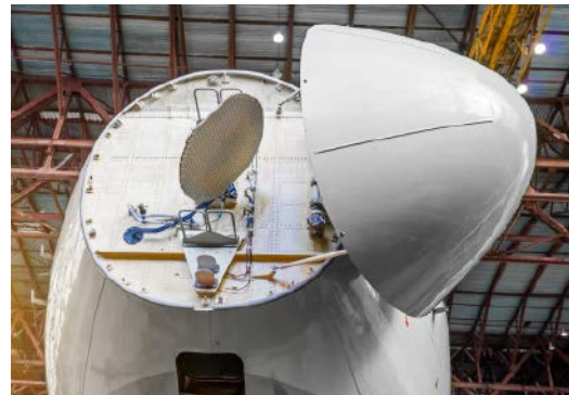
Radary meteorologiczne Dopplera montowane w nosie samolotu
