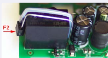
Rysunek 32. Bezpiecznik termiczny zamontowany w pobliżu obudowy przełącznika
