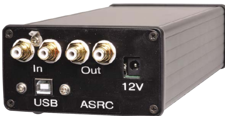
Oto jak powinna wyglądać tylna ścianka Twojego Super-Kodeka po skończonej pracy. Zwróć uwagę na komentarze w tekście dotyczące uziemienia/izolacji gniazd RCA, aby uniknąć pętli mas.
