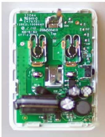
Rysunek 27. Kotki zasilające na środku są przylutowane
