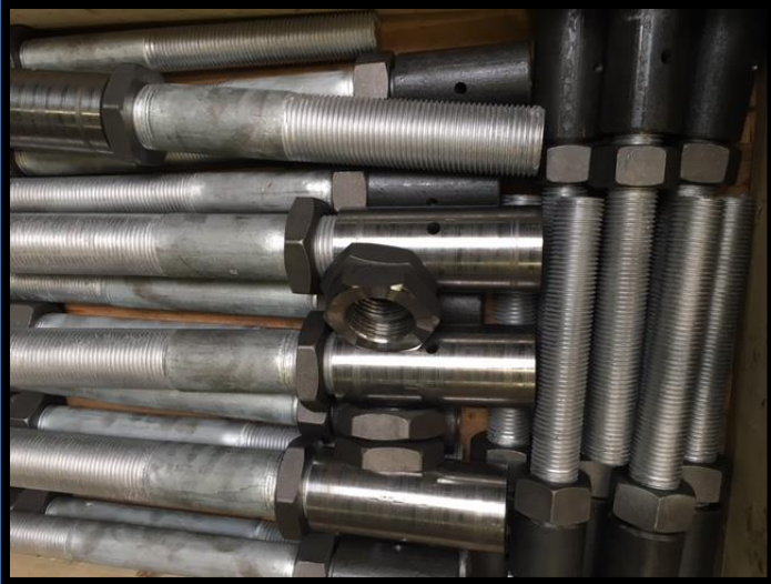
Ankerstangen M56 en M80 met opgelaste ring (thermisch verzinkt)
