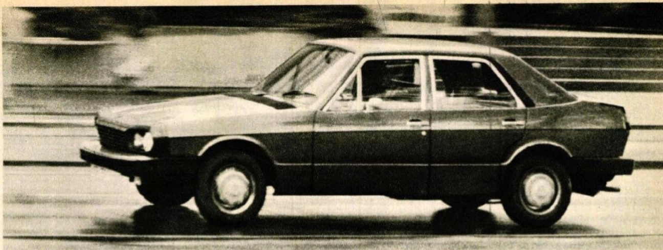
A VW-ESV kísérleti biztonsági autó, amely formailag inkább az NSU Ro-80-ra, mintsem bármelyik eddigi Volkswagenre emlékeztet, újszerű védőseket sejtét és ütközésbiztos oldalfalat mutat
