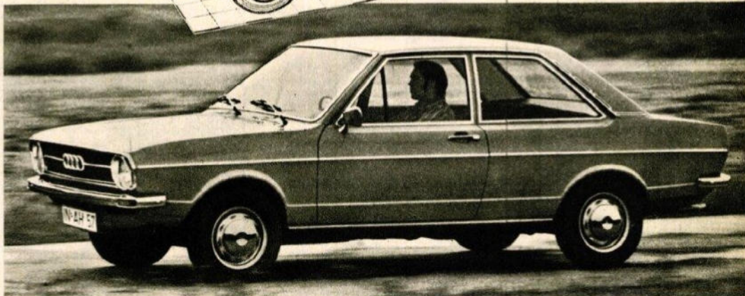
A 247 cm tengelytávú, 417,5 cm hosszú Audi-80, amelynek GL-változatával 170 km/óra sebesség érhető el
