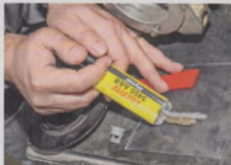
Az epoxi alapú fémragasztó két komponensét össze kell keverni
