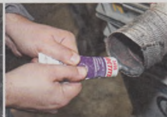
Csőillesztések tömítésére is jó a 800 fokig hőálló anyag
