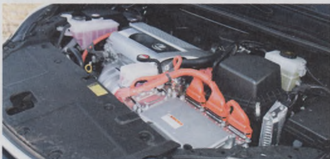
Szívó és kipufogó oldalon is változó szelepvezérlésű a 2,5-ös blokk
