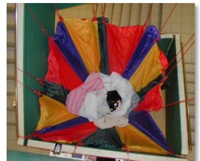
Die Getränkekiste ist mit einem Fallexperiment bestückt! Nach rund 2 Sekunden freien Falls in Schwerelosigkeit erfolgt die weiche Landung.
