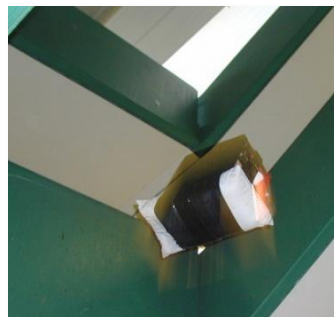
Die Getränkekiste ist mit einem Fallexperiment bestückt! Nach rund 2 Sekunden freien Falls in Schwerelosigkeit erfolgt die weiche Landung.
