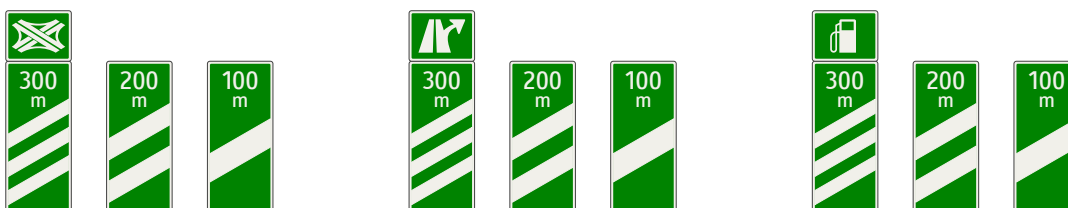
Obrázok 19: Odbočovacie majáčky pred uzlom, prípojkou a odpočívadlom s komplexnými službami
