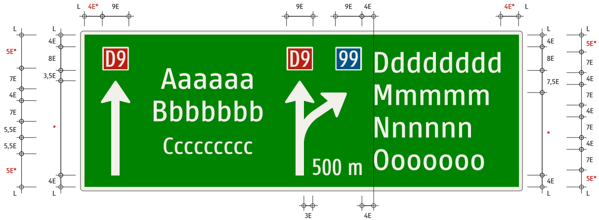
Návrhová schéma 31: Križovatková predzvesť nad vozovkou – vysoký formát, alternatívne umiestnenie vzdialenosti menej ako 1000 m
