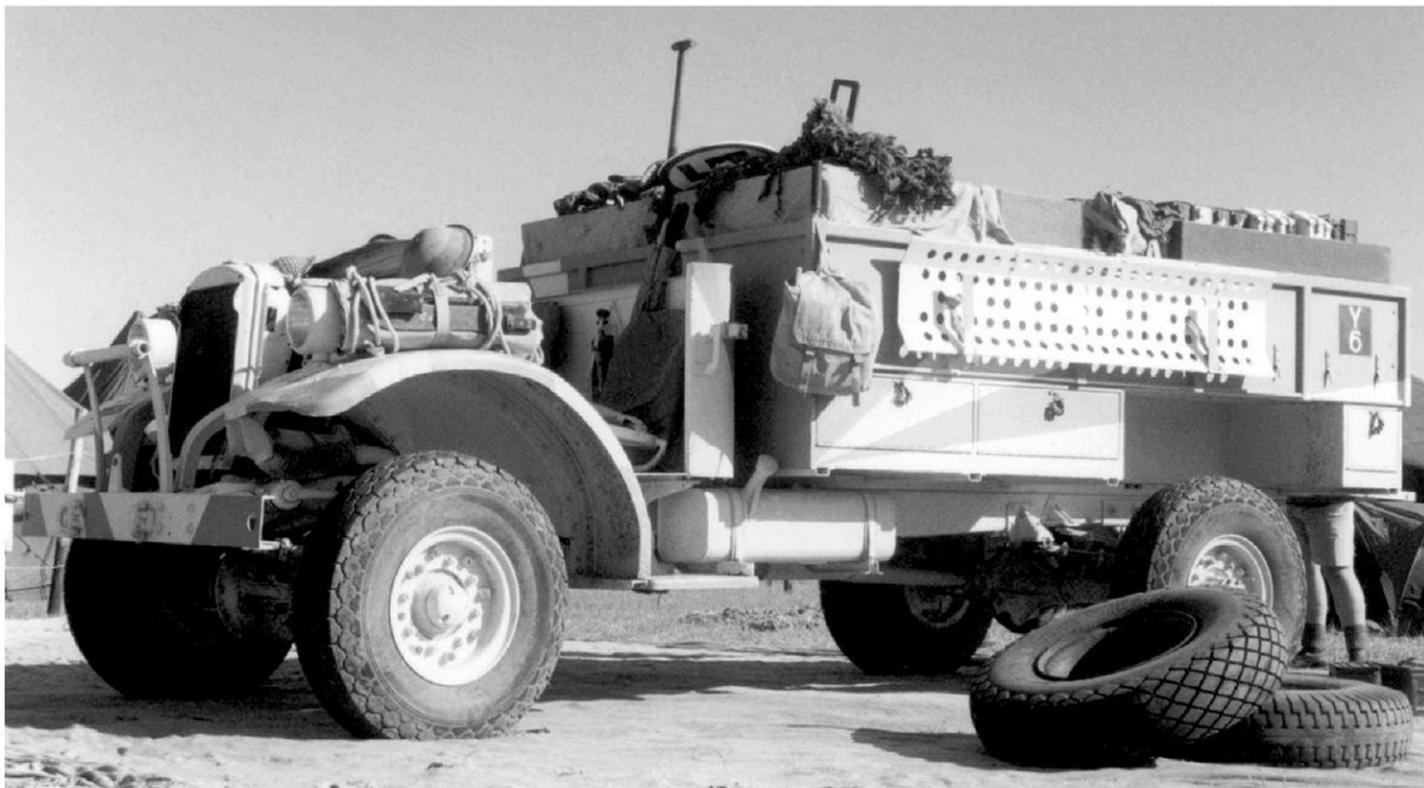
▲ Le capot de ce Ford 30 a été ôté pour faciliter l'aération et le refroidissement du moteur. On observe qu'il emporte un filet de camouflage mais aussi un panneau circulaire frappé d'un swastika : s'agit-il d'un leurre destiné à tromper un ennemi qui aligne des milliers d'engins britanniques ?
