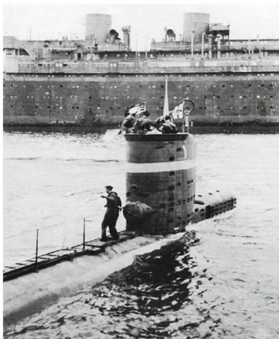
◀ Le U-2321 au départ d'une patrouille. La protubérance visible à la base du kiosque est le panneau d'un caisson contenant un radeau de survie gonflable. DR
