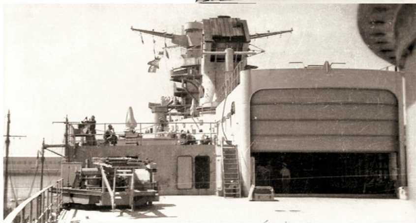
La cheminée et la tour du Jean-Bart en avril 1942. Les deux télépointeurs hérités du Dunkerque ne sont pas encore installés sur les côtés de la tour et une partie de la DCA manque toujours. (Dr. Thierry via Robert Dumas)
