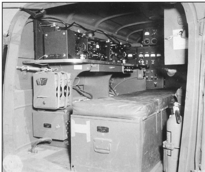
Autre vue sur l'équipement interne du K-51, le fond de la caisse est occupé par le gros transmetteur et la paroi gauche par le reste du matériel d'émission/réception. (Photo US Army SC-257528)
