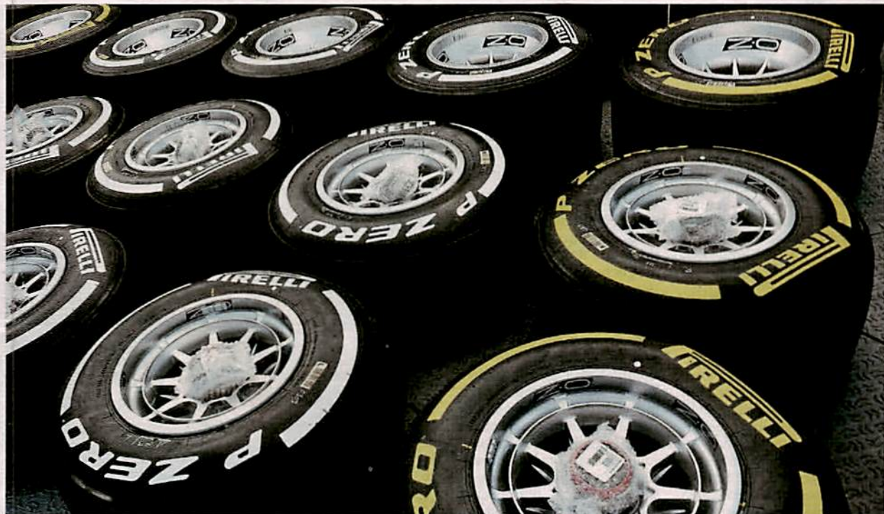
Zwei der vier Härtegrade der Pirelli-Slicks: Typ «Soft» (rechts) mit gelber Markierung und die weiß gekennzeichnete Sorte «Medium»
