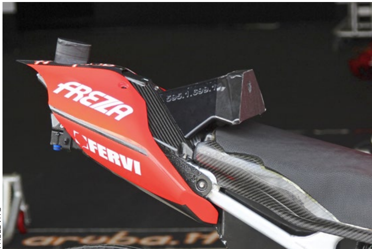
Wie in der MotoGP: Ducati baute einen Massedämpfer für die Werks-Panigale
