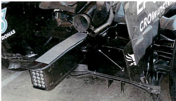
Die Wastegate-Röhrchen dürfen keine Luft mehr auf das Flügelchen blasen
