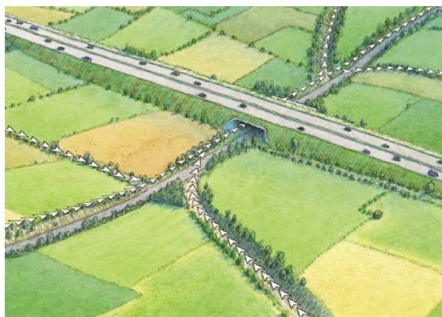
Rysunek 5.1.10.7-1 Sposób ukierunkowania przelotów nietoperzy pod most (wg Limpensa 2005).
