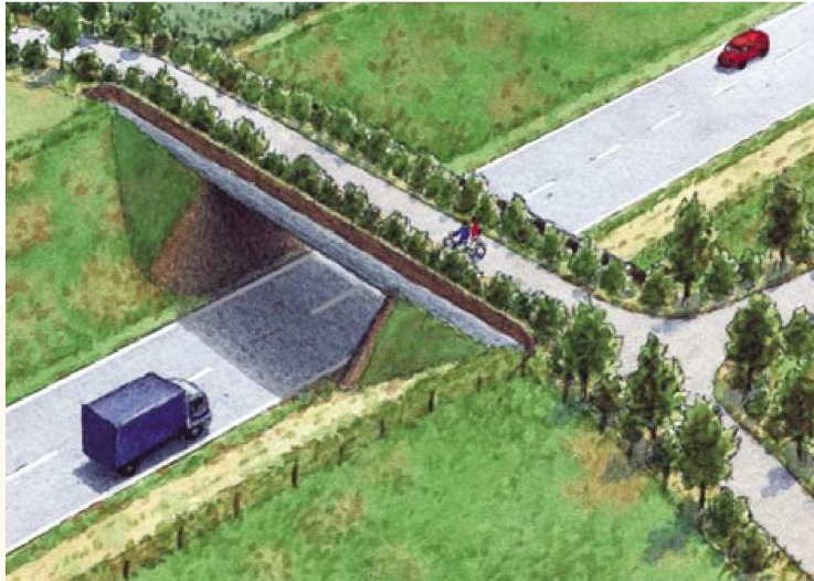
Rysunek 5.1.10.7-4 Sposób ukierunkowania przelotów nietoperzy w przypadku przebiegu drogi krajowej nad drogą ekspresową (wg Limpensa 2005) – rysunek poglądowy, również w przypadku przejść górnych.
