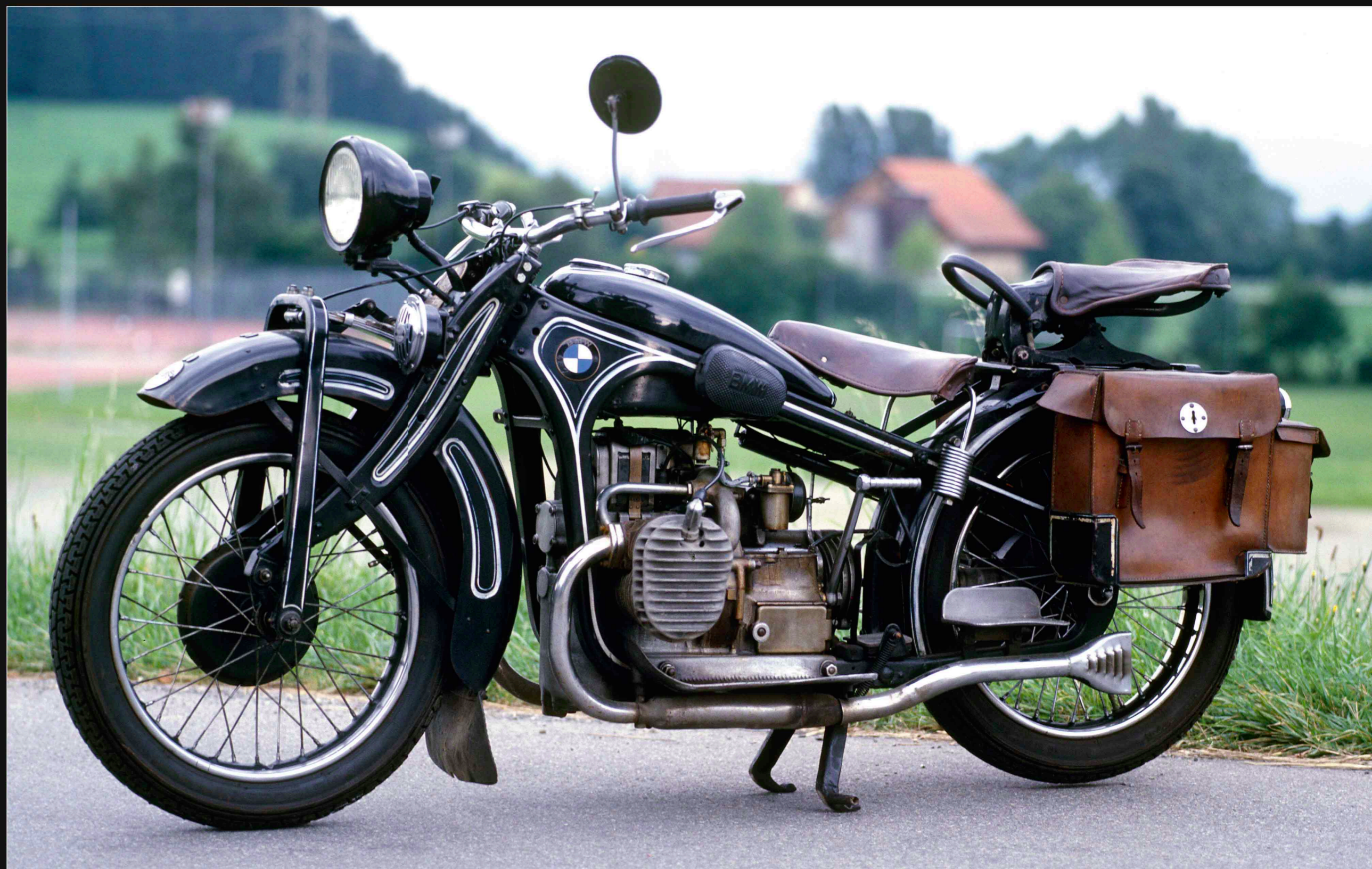
Restaurierte R 11 Serie 4 von 1933 mit Zentralvergaser und Zubehör, fotografiert 1990.
