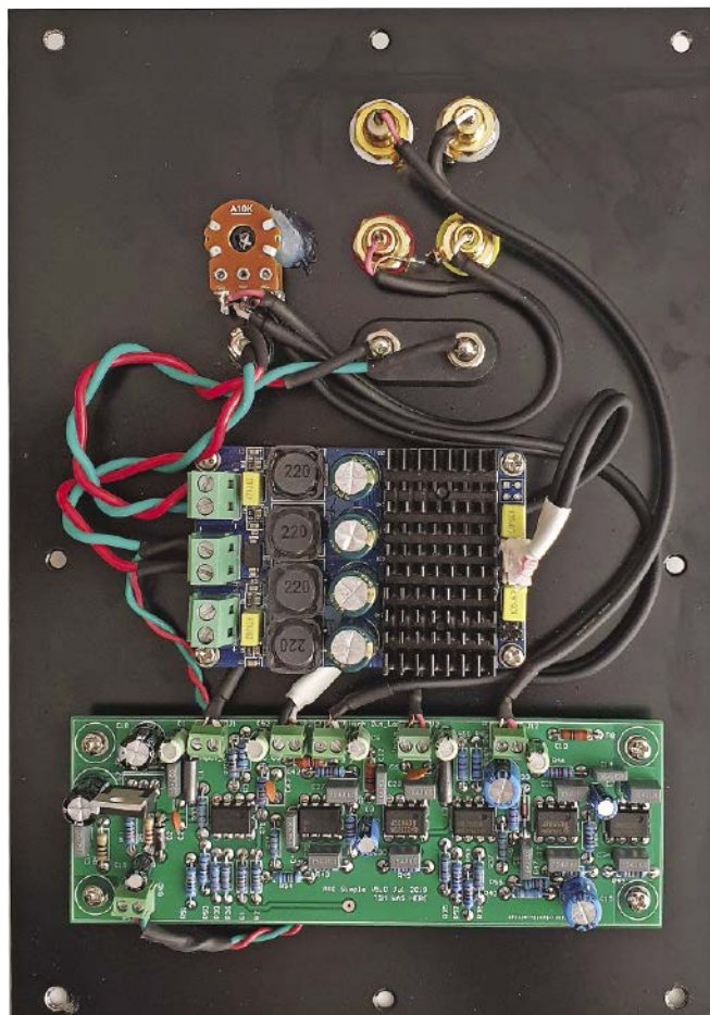
Oto fotografia gotowej płyty wzmacniacza/zwrotnicy pokazanej na schemacie montażowym poniżej (rysunek 19). Jedynie co warto dodać to kilka pasków zaciskowych, aby uporządkować całe okablowanie
