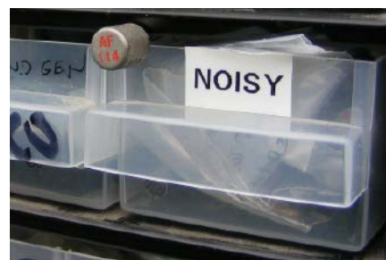
Rysunek 2. To moja szuflada, gdzie zgromadziłem szumiące elementy; mam tu np. germanowe tranzystory AF114 produkcji 1965; szumią jakby zawierały radioaktywny izotop w swojej strukturze
