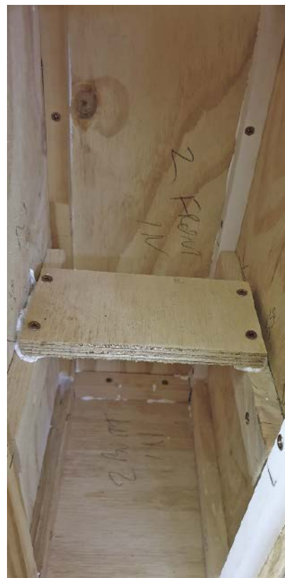
Rysunek 17. Panele subwooferów są wycięte z trzech arkuszy sklejki o wymiarach 600×1200 mm. Podobnie jak w przypadku monitorów, można przeciąć dwa arkusze przez środek. Aby nie trzeba było kupować czwartego arkusza na jeden panel przedni, ostatni element jest wykonany z jednego z odciętych arkuszy głośników półkowych (patrz rysunek 13, w poprzednim numerze EdW)
