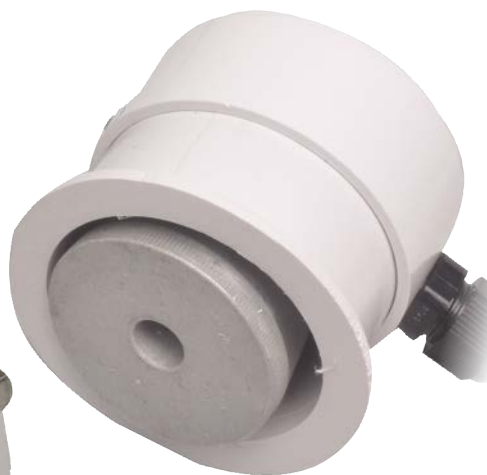
Oto przetwornik (po lewej) i przetwornik wewnątrz naszej „specjalnej obudowy hydraulicznej” z kształtek PCW. To zdjęcie zostało zrobione przed przyklejeniem do pojemnika myjki.
