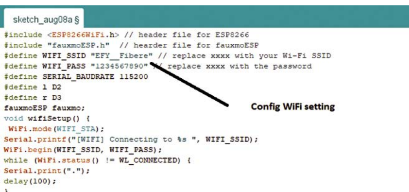
Rysunek 8. Fragment kodu źródłowego z liniami nazwy i hasła lokalnej sieci Wi-Fi
