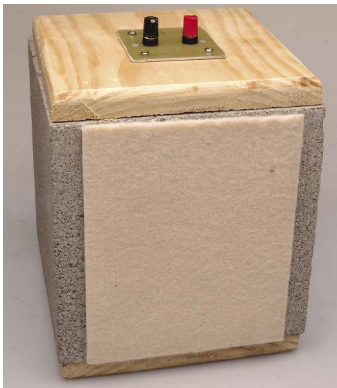
Gotowy głośnik półkowy, tutaj pokazany od spodu, z kawałkiem cienkiego filcu 170×170 mm przyklejonym do bloku, aby nie rysował powierzchni pod spodem
