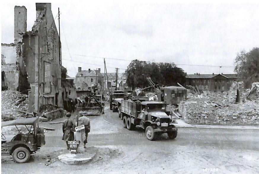
▲ Isigny-sur-Mer : un convoi de CCKW 353 chargés de matières explosives passe devant un GMC HI du génie. Le ballet est réglé par un MP. Sur le pare-chocs avant du GMC, on peut lire « 1A-3703QM », signifiant qu'il appartient à la 3703rd Quatermaster Truck Company de la 1st US Army, une compagnie dépendant du 471st QM Group. US Nara
