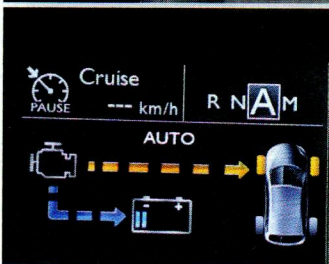
A dízel-hibrid folyamatábrára is megjeleníthető a kijelzőn. A robotváltó kurta karja mellett található a hibrid üzemmód forgókapcsolója
