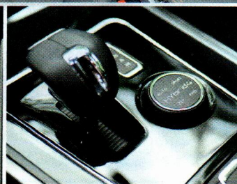
A dízel-hibrid folyamatábrára is megjeleníthető a kijelzőn. A robotváltó kurta karja mellett található a hibrid üzemmód forgókapcsolója
