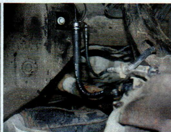
Az új fékcsövek beszerelve, jöhet a fékolaj visszatöltése
