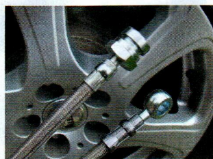
Az új fékcsövek beszerelve, jöhet a fékolaj visszatöltése
