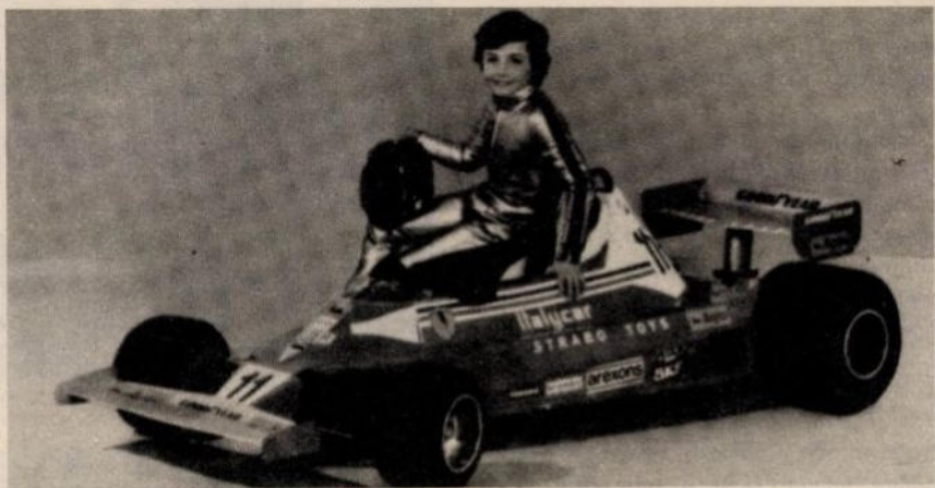
Ez a kis versenyautó a Forma-1-es Ferrari hasonmása. A stuttgarti Steinwinter cég mini Ferrarijába 50 cm 3 -es egyhengeres, kétütemű motort épít. A 100 kilós, 80 km/órás sebességre képes versenyautó kerekeit tárcsafékek őrzik
