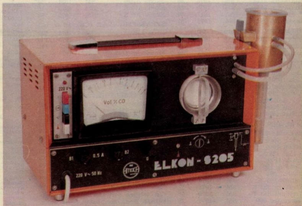
Az ELKON—S 205 Infra CO készüléket a szén-monoxid mérésére használják. Pontos mérése hathatós segítséget nyújt a környezetvédelemben és az energiazdálkodásban
