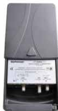
▶ ΚΩΔ.: LM-SAT DIG ΕΝΙΣΧΥΤΗΣ ΓΡΑΜΜΗΣ IN 47-2300MHz GAIN: 12-18dB OUT 47-862MHz: 90dBμV 950-2300MHz: 100dBμV
