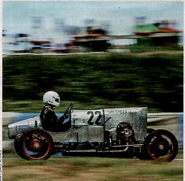
Eine der Kuriositäten: GN Spider II Special (1938) mit Kettenantrieb
